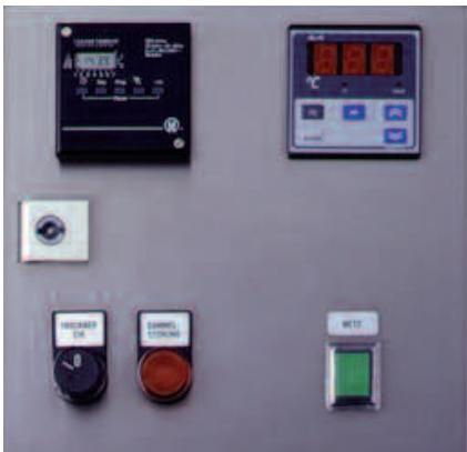
Die SPS-Steuerung ermöglicht einfache Bedienung und Überwachung des Kleintrockners. Auftretende Störungen werden angezeigt! Für jeden Wochentag können individuelle Ein- und Ausschaltzeiten vorgewählt werden.
